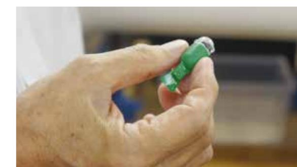
全消化管の内視検査を実現する自走カプセル内視鏡
