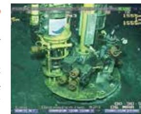
自然界に存在する海底温泉を対象とした掘削航海を実施し、海底熱水鉱床を養殖する装置を設置することで、銅・鉛・亜鉛・金・銀に富む鉱石を養殖・生産する。日本の排他的経済水域内には、20を超える海底熱水サイトが存在しており、自国内からの金属資源の供給を目指す。
