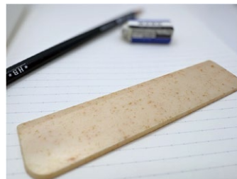
地域の間伐材の端材にベホマルのCO 2 吸収素材を混ぜ込んでつくられた国産ストランドボード
