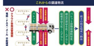
複数のサプライヤーを巡回して集荷する「ミルクラン方式」。個別輸送をまとめることで、輸送回数の削減と積載効率の向上を実現する。
